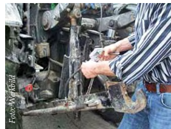
Paraffin-Schmiermittel, wie das rote Fett von OzOil sind deswegen besonders dicht und lassen weder Wasser noch Partikel eindringen.
